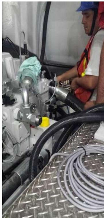
**Figura 72.- Conexión de sistema hidráulico unidad de inyección y unidad de cierre.**
