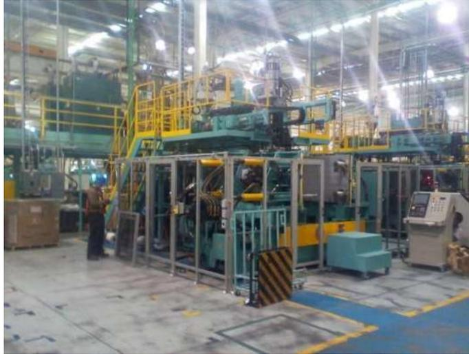
**Figura 19.- Máquina de inyección de plástico Mann-Hummel parque Querétaro**
