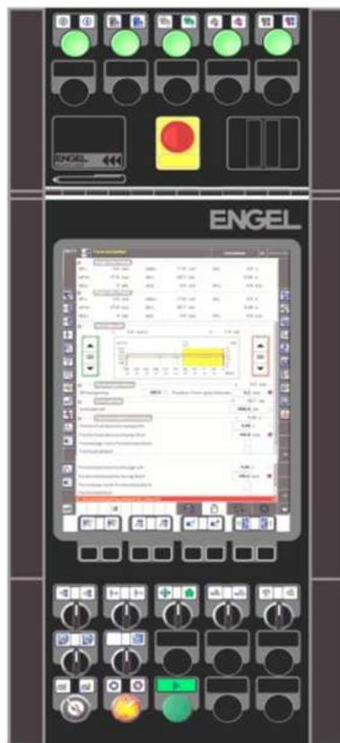
**Figura 12.- Control CC200 con selectores sin retención<sup>12</sup>**
