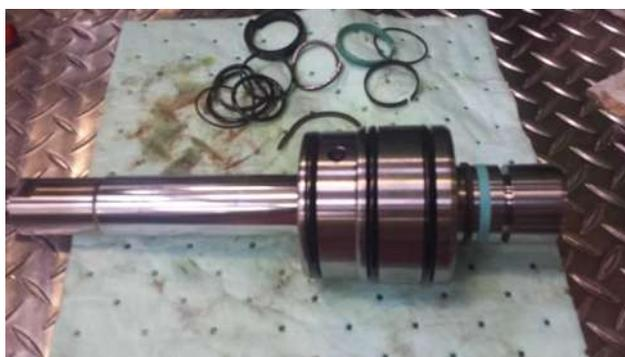
**Figura 48.- Cambio de sellos y o-ring de vástago y barril finalizado**
