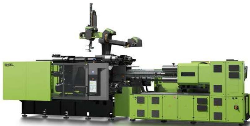
*Figura 57.- Máquina de moldeo por inyección e-DUO<sup>28</sup>*
