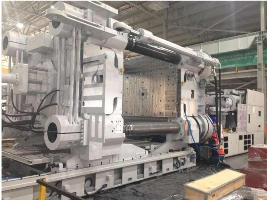
**Figura 63.- Acople de platinas finalizado**
