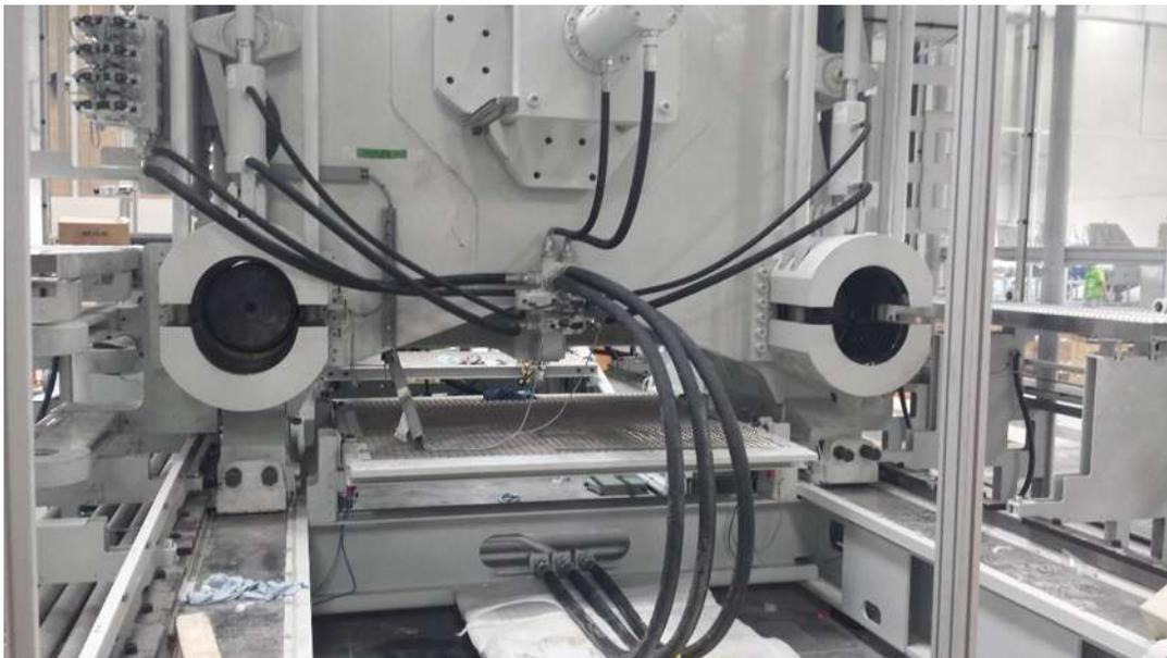
*Figura 70.- Conexión de sistema hidráulico platina móvil parte trasera.*
