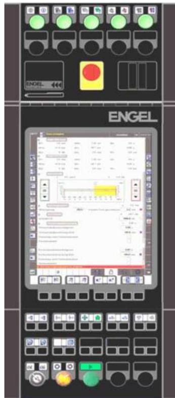
**Figura 13.- Control CC200 con botones en membrana y pantalla touch screen tipo resistivo.<sup>13</sup>**
