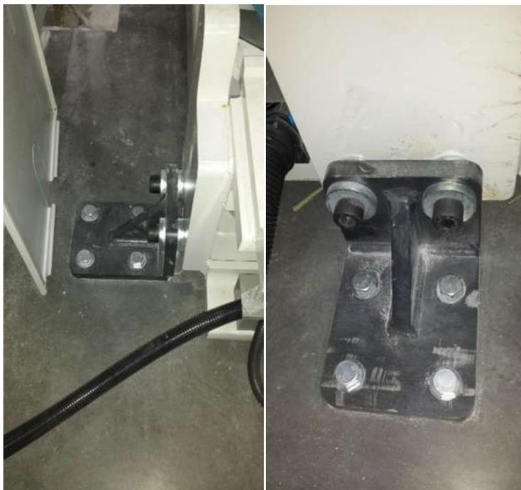
**Figura 84.- Anclas mecánicas de máquina**
