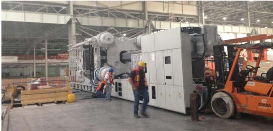
**Figura 71.- Colocación de unidad de inyección.**
