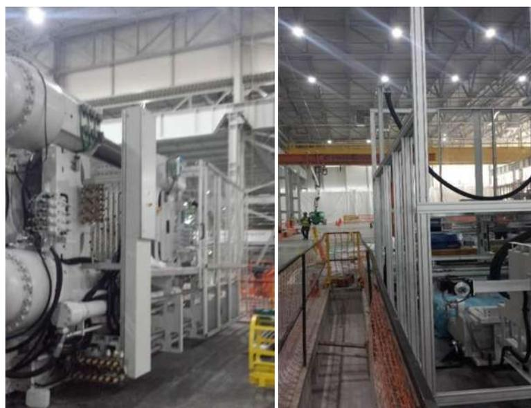
***Figura 68.- ensamble de estructura de unidad de cierre***
