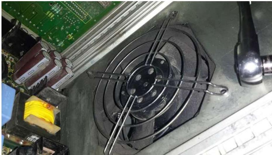
*Figura 37.- Ventilador con exceso de polvo lo cual se refleja en calentamiento y mala circulación de aire*
