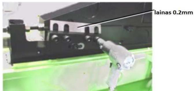
Figura 80.- Ajuste de centricidad de platinas<sup>30</sup>
