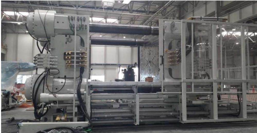
*Figura 69.- Unidad de cierre finalizada en ensamble.*
