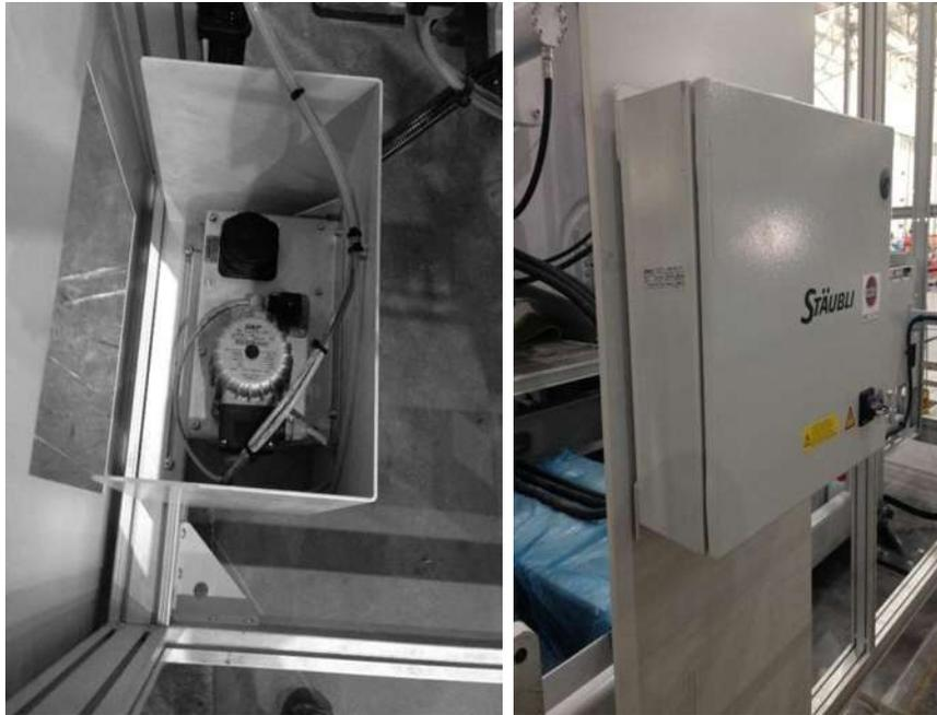
**Figura 77 .-Unidad de mantenimiento bomba de lubricación (izq.), gabinete de control platinas magnéticas (der).**
