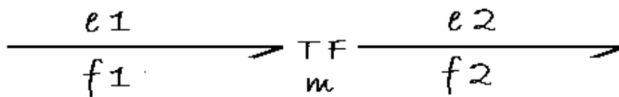
Figura 2.9 Representación del transformador en Bond Graph.
