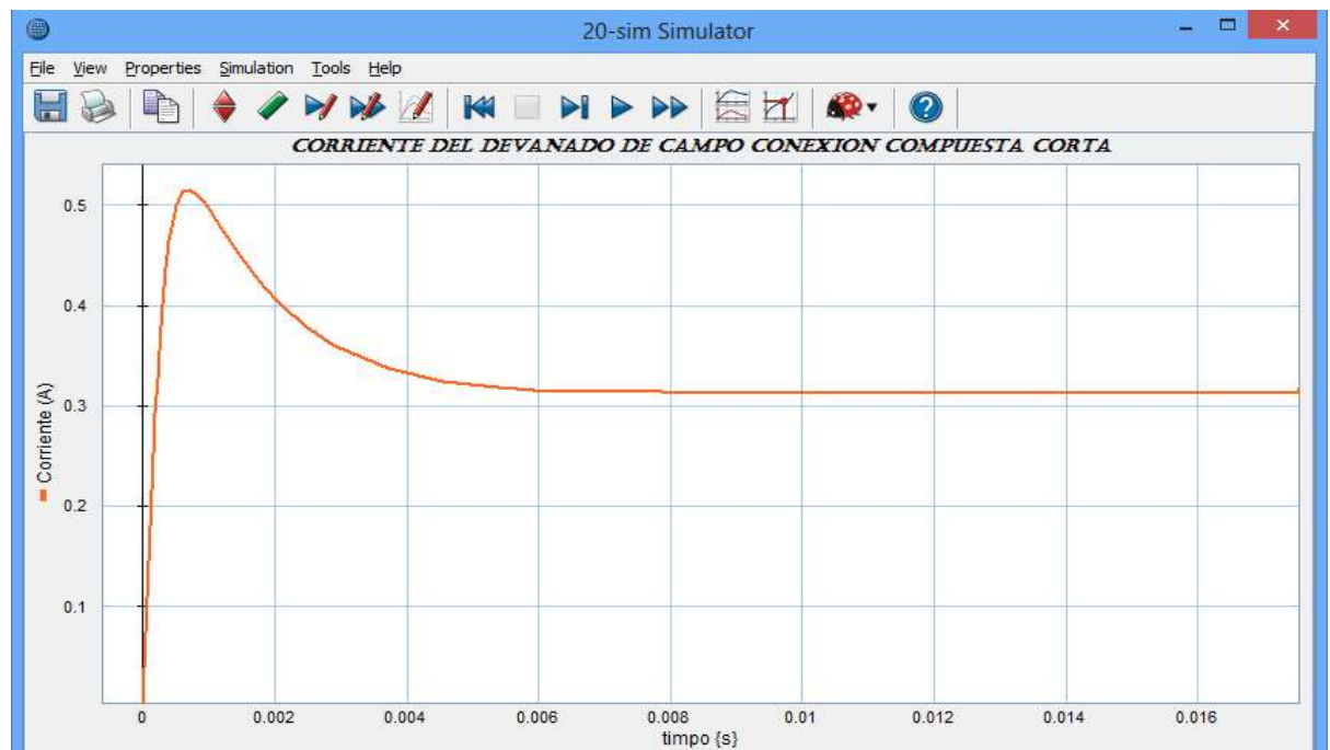
Figura 4.23 Corriente del devanado de campo, conexión compuesta corta.
