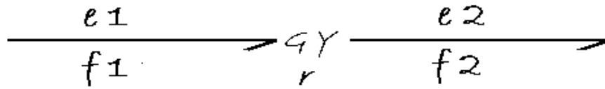
Figura 2.10 Representación de un girador en Bond Graph (GY).
