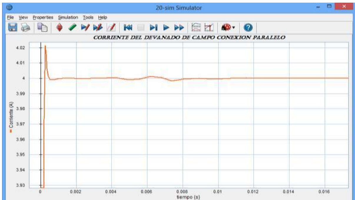
Figura 4.16 Corriente del devanado de campo, conexión paralelo.
