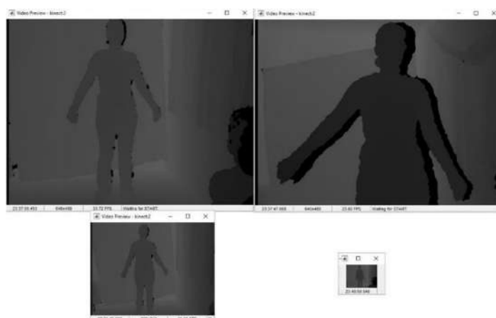
Figura 48 Sensor de profundidad, 1) 640x480 lejos, 2) 640x480 cerca, 3) 320x240 lejos, 4) 80x60 lejos
