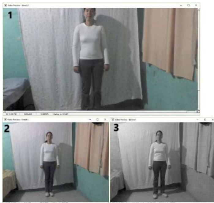
Figura 47 Sensor Color, 1) RGB 1280x980, 2) RawBayer 640x480, 3) RawYUV 640x480
