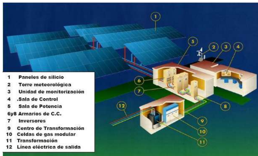
Figura 2.7 Centrales Solar Fotovoltaico
