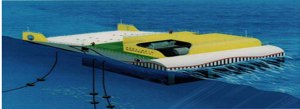
Figura 3.14 Dispositivo flotante conocido como Mighty Whale
