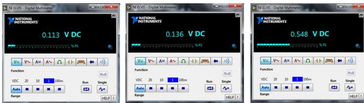
Figura 4.26 Voltaje obtenido por la radiación de los tres tipos de lámpara a 1m de distancia
