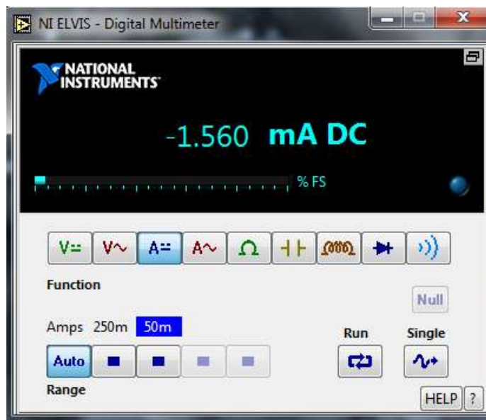
Figura 4.6 Ventana del DMM como medidor de ADC de NI ELVIS
