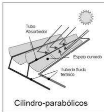
Figura 2.4 Colector solar de media temperatura
