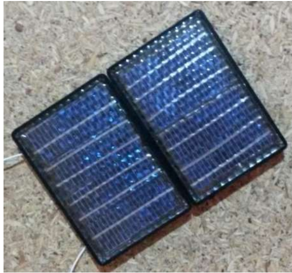
Figura 4.22 Celda fotovoltaica policristalina
