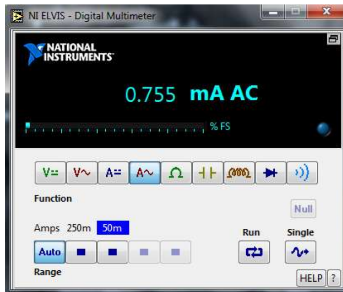
Figura 4.7 Ventana del DMM como medidor de AAC del NI ELVIS
