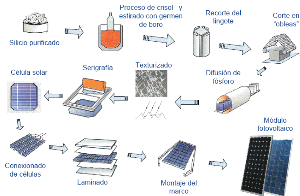
Figura 3.6 Proceso de construcción
