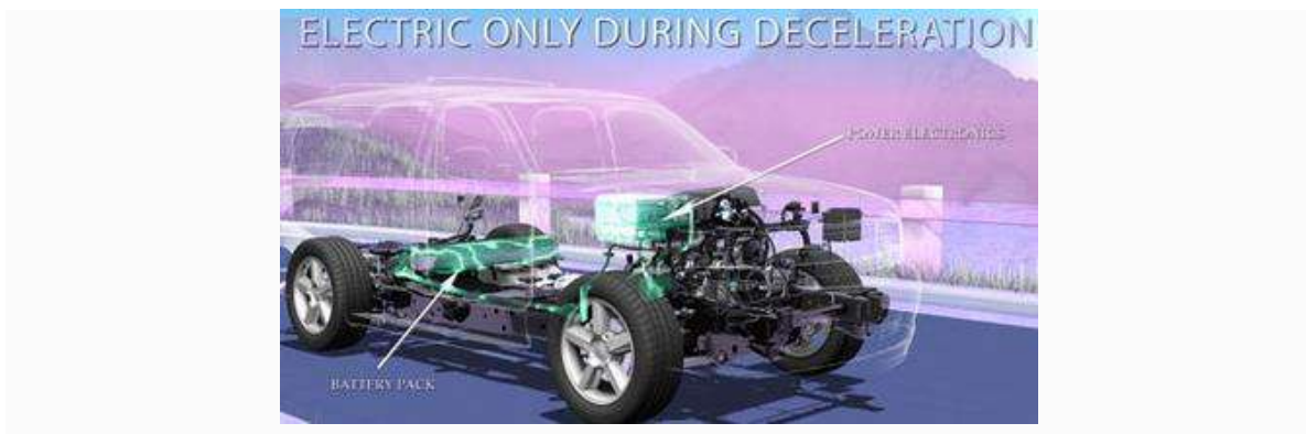
Figura 2.19: Auto eléctrico sólo durante la desaceleración
