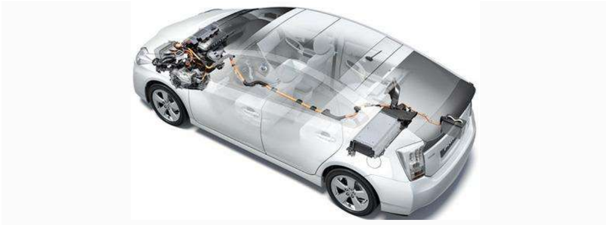
Figura 2.17: Posible configuración de auto híbrido
