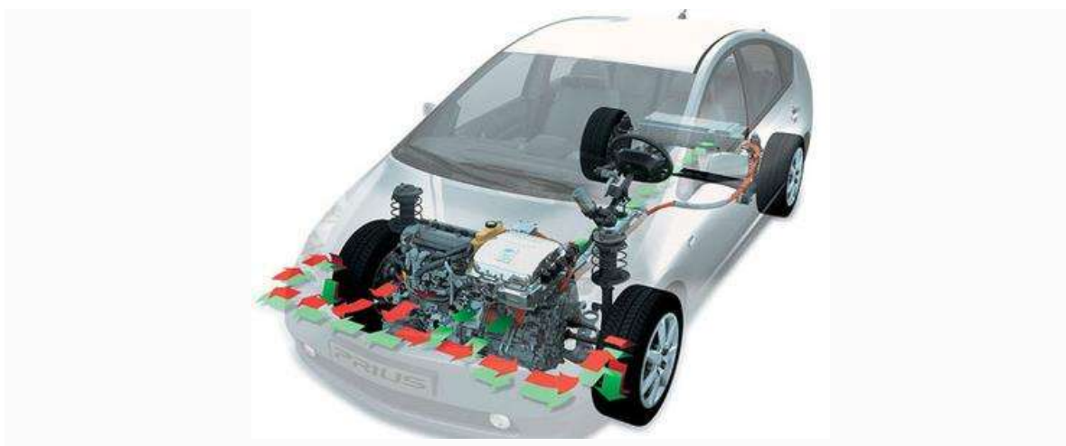
Figura 2.15: Motor térmico e híbrido ambos acelerando simultáneamente
