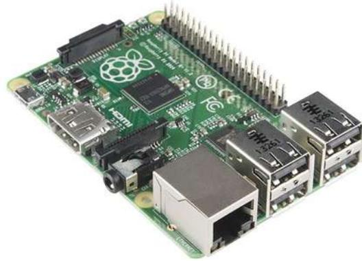
**Figura 1-20 Raspberry Pi modelo B+.**
