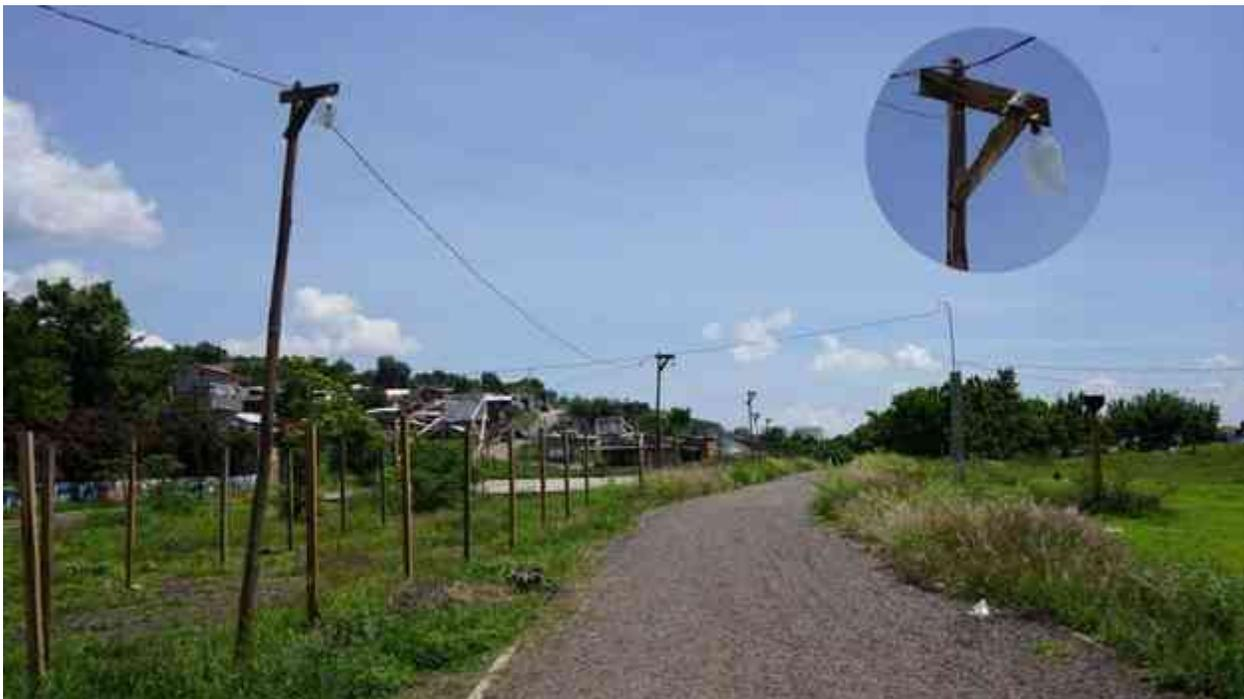
*Figura 5.28\_* Fotografía que muestra la presencia de luminarias improvisadas fabricadas con recursos precarios por los vecinos, para iluminar el espacio público.
