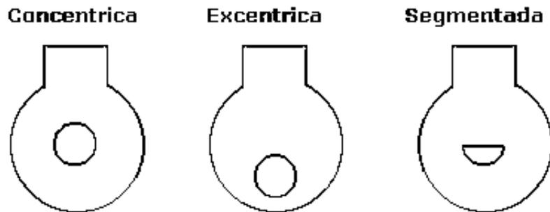
Figura 2.1 Tipos De Placas De Orificio
