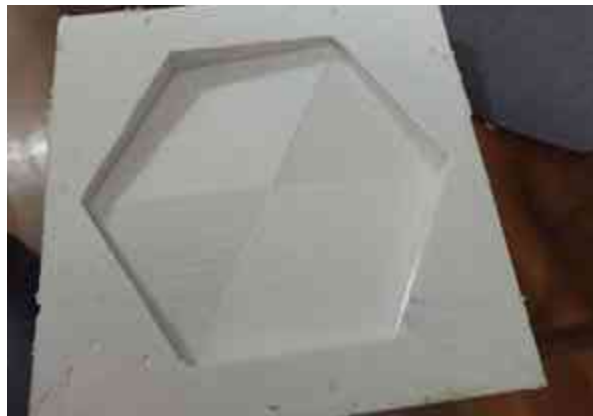
Fig. 71 Molde de silicona para fabricar prototipos de concreto
