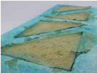
Fig. 65 Molde con prototipos de concreto con fibras vegetales.
