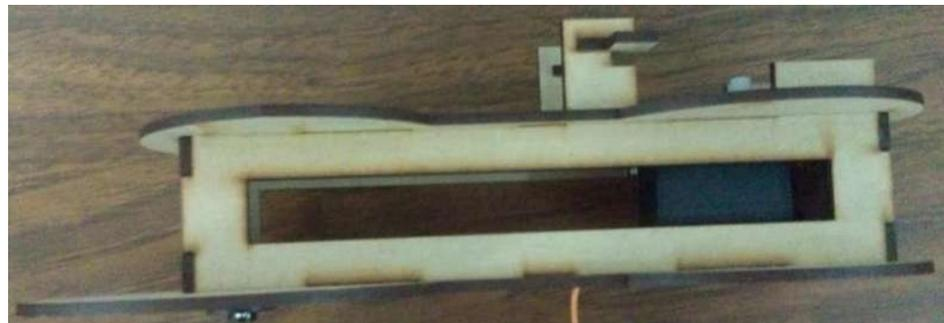
**Figura 4.13: Primer Eslabón del Brazo SCARA (Vista Lateral)**
