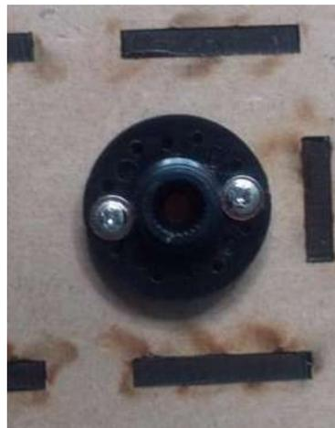
**Figura 4.4: Sujeción del Acoplador a la Estructura**
