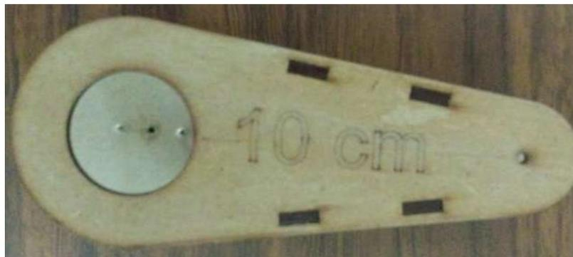
**Figura 4.21: Tercer Eslabón del Brazo PUMA (Vista Lateral Izquierdo)**
