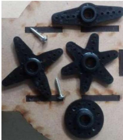
**Figura 4.3: Acopladores para el Servomotor**
