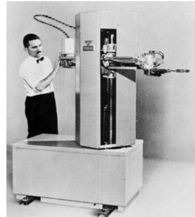
**Figura 2.2: Robot Comercial VERSATRAN**
