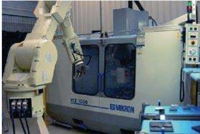
**Figura 1.6: Robot Industrial KAWASAKI de Carga/Descarga**
