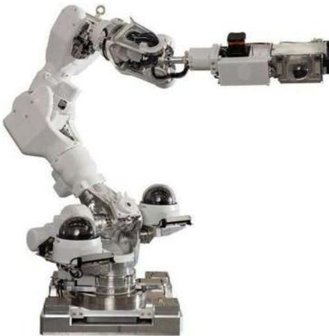
**Figura 1.13: Robot para Estación Nuclear TEPCO**
