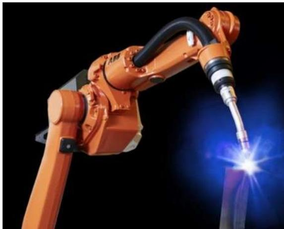
**Figura 1.3: Robot Industrial para Soldadura ABB**
