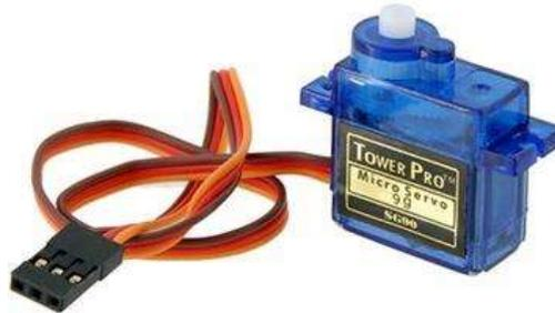
**Figura 3.21: MicroServo Tower Pro SG90**
