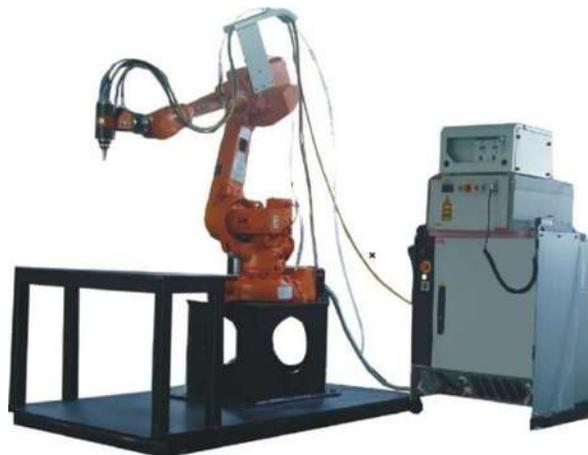
**Figura 1.8: Robot Industrial para Corte Láser SUNTOP**
