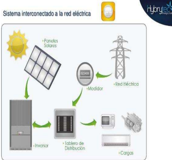
Figura 3. 6 Sistema solar fotovoltaico conectado a la red [42]
