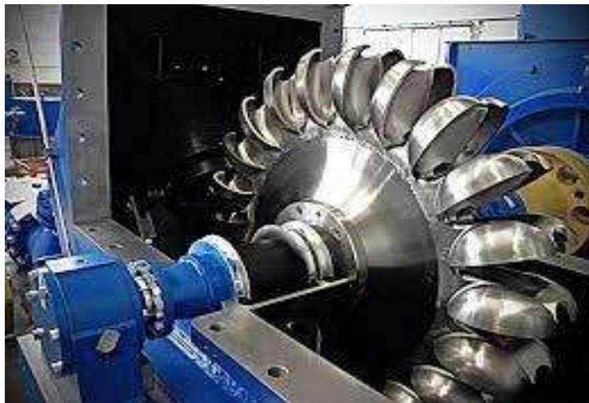
Figura 2. 8 Turbina Pelton (Potencia nominal de casi 5000 KW de potencia)
