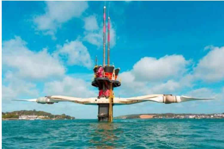
Figura 2. 2 Generador de corriente de marea
