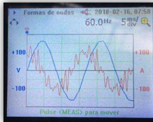
Figura 4.18 Forma sinusoidales de corriente y voltaje del circuito capacitivo en el laboratorio de eléctrica
