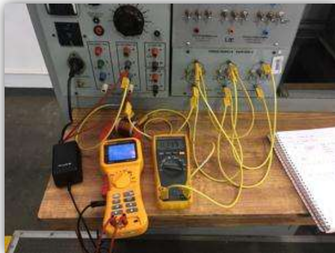
Figura 4.4 Configuración de circuito puramente resistivo en el laboratorio de eléctrica
