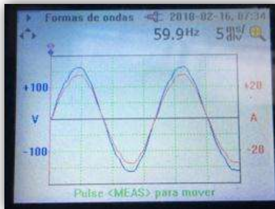
Figura 4.6 Formas sinusoidales corriente y voltaje del circuito resistivo en el laboratorio de eléctrica
