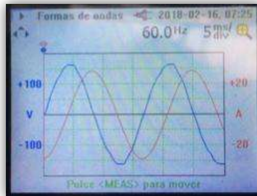
Figura 4.12 Forma sinusoidal corriente y voltaje del circuito inductivo en el laboratorio de eléctrica
