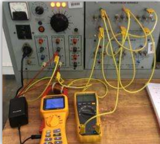
Figura 4.10 Configuración de circuito puramente inductivo en el laboratorio de eléctrica
