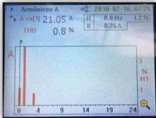
Figura 4.14 Contenido THD en la corriente de circuito inductivo tomado del laboratorio de eléctrica, medida por un analizador de armónicos
