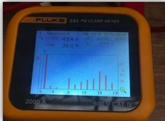
Figura 4.20 Contenido THD en la corriente de circuito capacitivo tomado del laboratorio de eléctrica, medida por un analizador de armónicas
