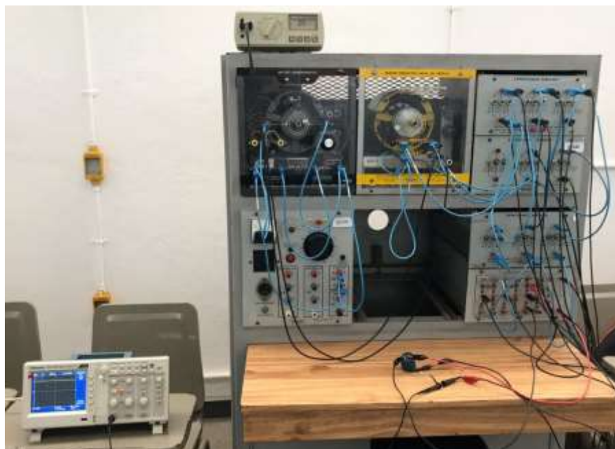
Figura 4.17 Circuito experimental del rectificador trifásico.
