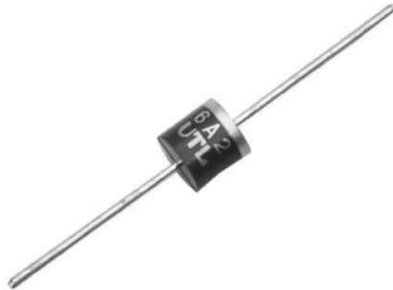
Figura 3.16 Diodo rectificador de baja frecuencia.
