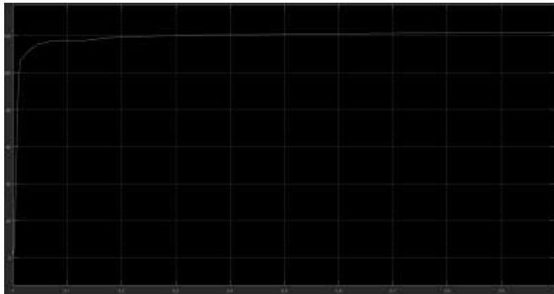
Figura 4.8 Señal del rectificador con capacitor de compensación.
