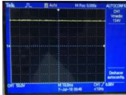
Figura 4.16 Señal del rectificador conectado al generador asíncrono con carga y con capacitor de compensación
