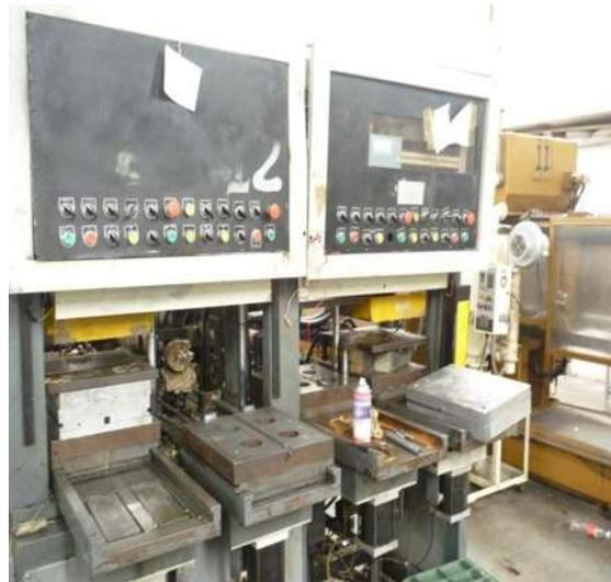
Figura 13.- Máquinas de inyección de suela
