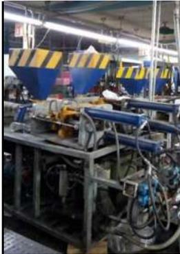
**Figura 52.- Máquina de Inyección de Suelas NUM.10.**
