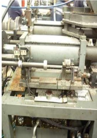
**Figura 21.- Pistón hidráulico para inyectar.**
