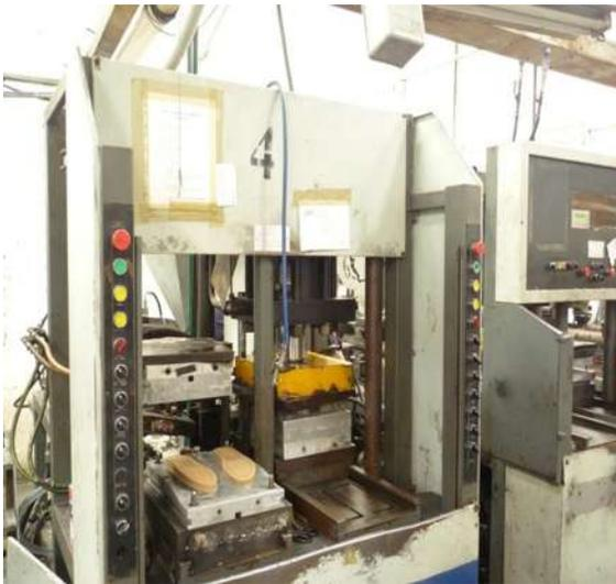
Figura 12.- Máquinas de inyección de suela
