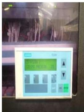
**Figura 29.- Panel TD200 para PLC-STEP-7200.**
