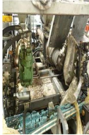
**Figura 22.- Motor hidráulico para inyectar.**
