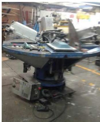
**Figura 58.- Máquina Automática de Pegar Calzado.**
