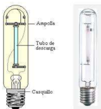
Figura 27.- Bombilla Vapor de Sodio de Alúbrado Público
