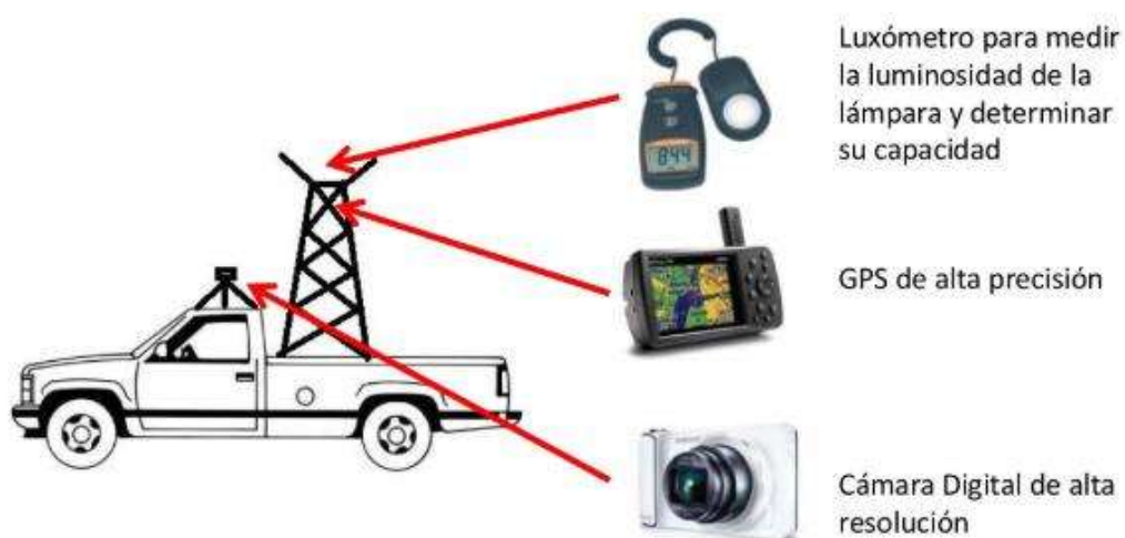
Figura 22.- Vehículo para levantamiento del Censo de Alumbrado Público
