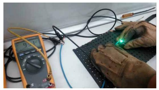
Figura 4-22 Imagen del falso contacto provocado con carga de 360 w.
