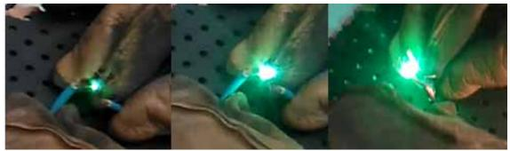
Figura 6-1 Imágenes de la flama del falso contacto en CD.
