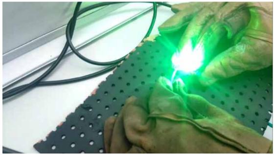
Figura 4-15 Imagen del falso contacto provocado con carga fija de 40  $\Omega$ .
