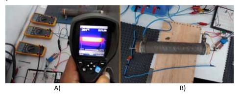
Figura 4-11 Imagen A) registro de temperatura, B) Circuito ejecutado con carga fija de 40  $\Omega$  .
