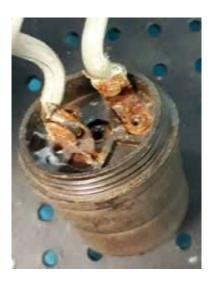
Figura 4-5 Socket utilizado para la prueba de corrosión.
