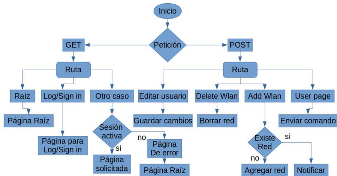
Figura 41: Diagrama de funcionamiento, Servidor HTTP
