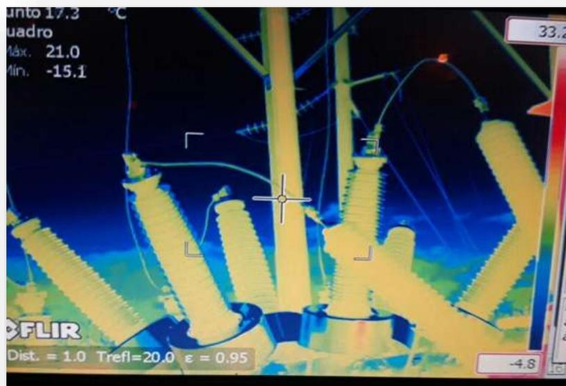
**Figura 4.50 Revisión termográfica en interruptor de tanque muerto 115 kV**
