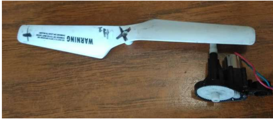
Figura 27 Motor con sus respectiva hélice y engranaje para aumentar el torque
