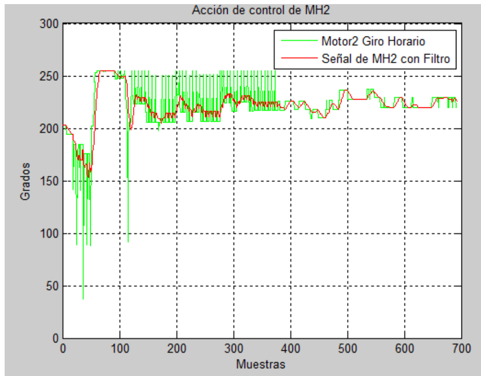
Figura 63. Gráfica de la acción de control para el motor 2 con giro horario.
