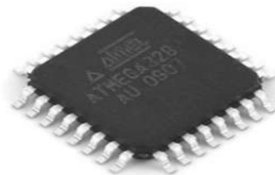
Figura 23. Microcontrolador ATmega 328 utilizado por la placa Arduino nano
