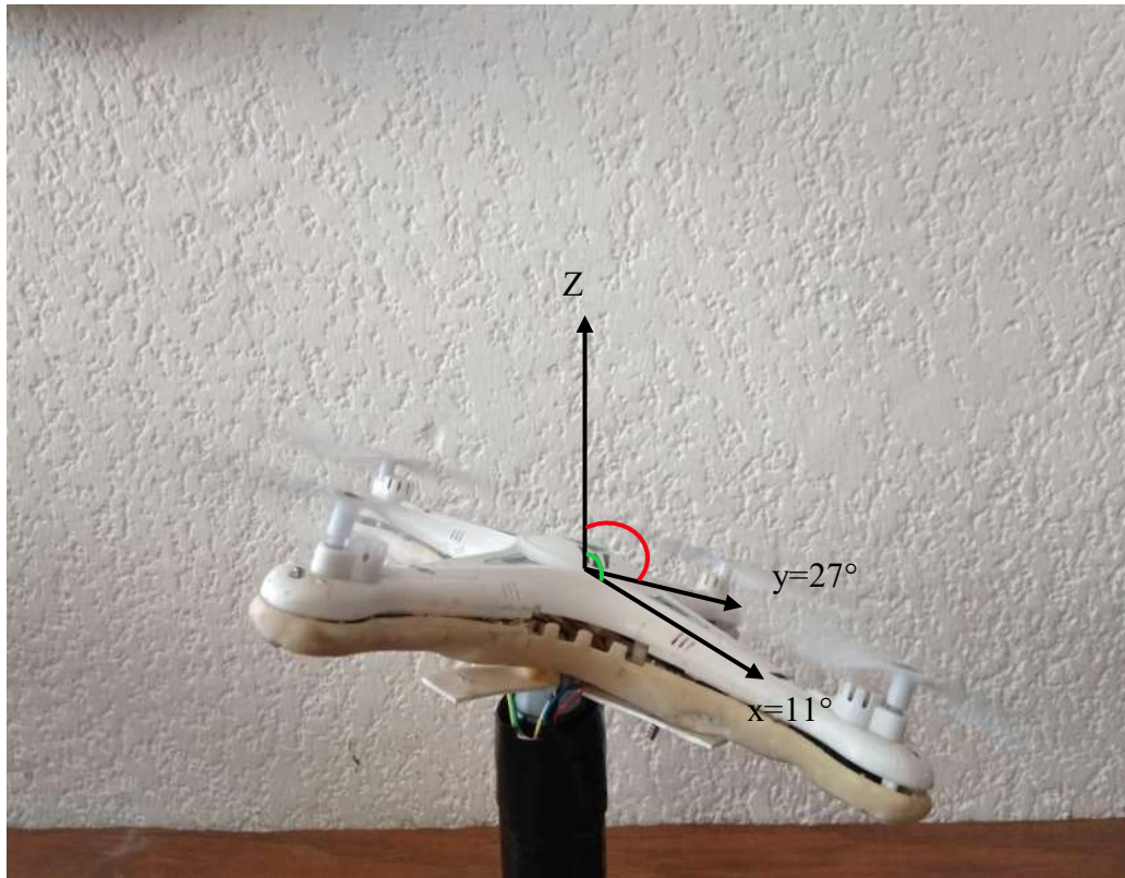
Figura 52 Imagen que muestra al Cuadricóptero en su posición inicial en la cual se toman los datos para su respuesta del controlador implementado con referencia de cero grados en ambos ejes.
