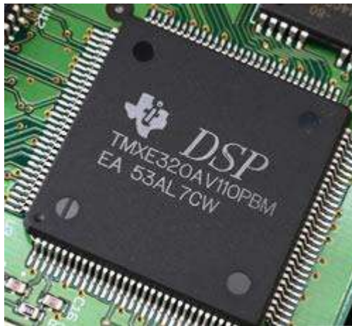
Figura 1 Ejemplo de un DSP creado por TI.
