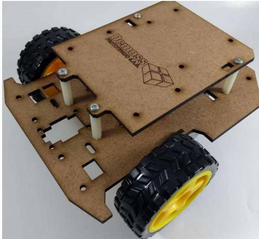
Figura 84 Chasis de MDF (Imagen obtenida de Demoss.com)
