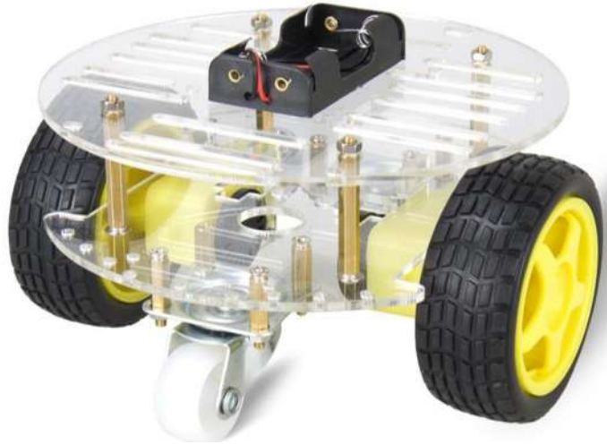
Figura 85 Chasis de acrílico (Imagen obtenida de googleimages)
