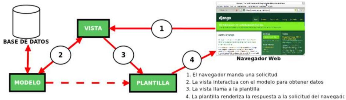
Figura 2.5- Funcionamiento del MTV de Django
