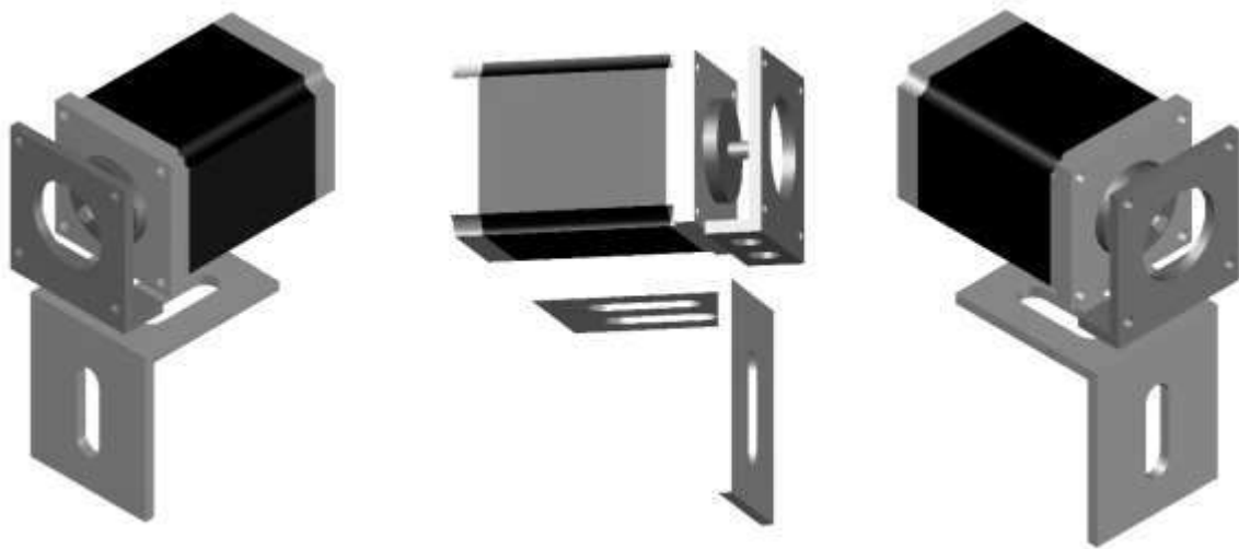
Figura 4.18: Modelo en 3D del diseño físico de la base para el motor de pasos.
