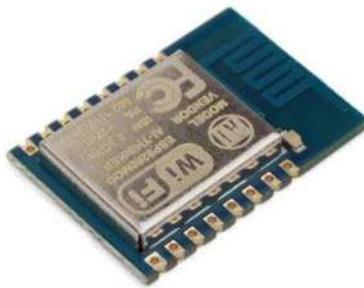
Fig. 3-9. Módulo ESP-12E [28].
