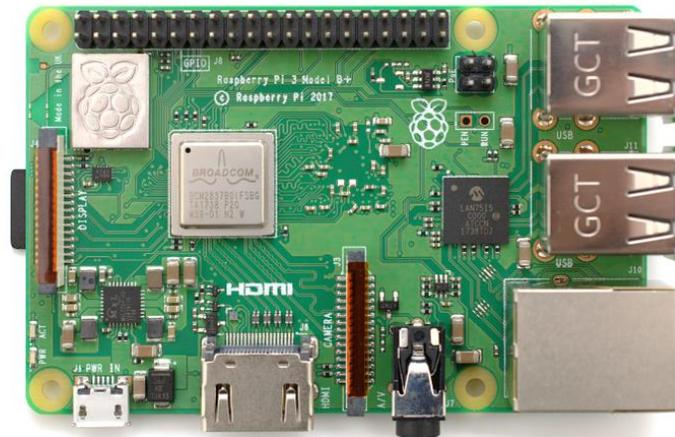
Fig. 2-7. Ordenador de Placa Única (SBC) marca Raspberry Pi modelo 3B+ [30].
