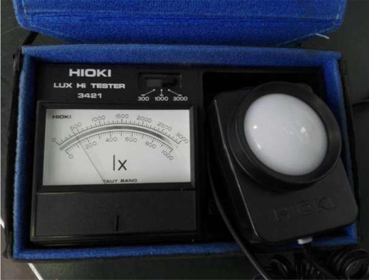
Fig. 3-20. Luxómetro Hioki LUX Tester 3421.
