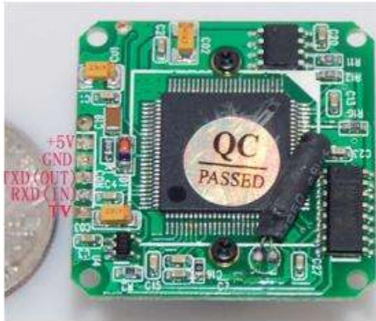
Fig. 3-16. Pines disponibles en la cámara LinkSprite modelo LS-Y201 [82].
