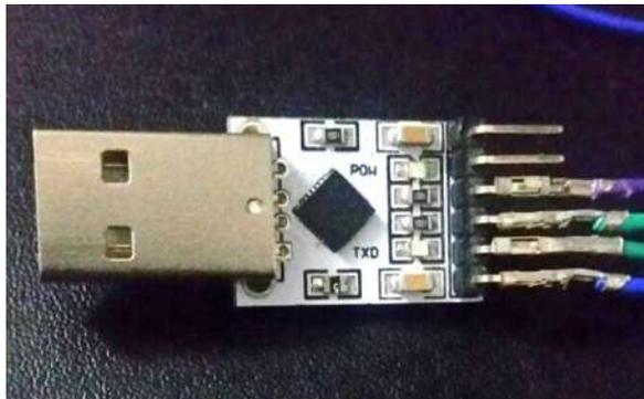
Fig. 5-1. Convertidor USB-Serial utilizado en el proyecto.
