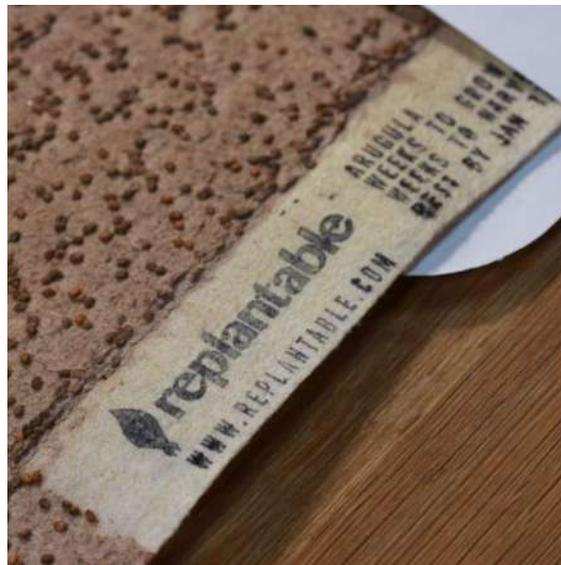
Fig. 1-12. Película de pulpa reciclada con semillas y nutrientes [15].
