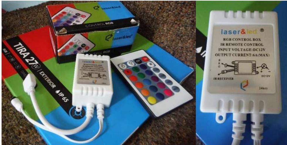
Fig. 3-31. Caja receptora de IR y control remoto marca laser&led.
