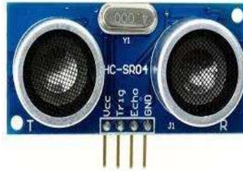
Figura 18. Sensor ultrasónico HC-SR04
