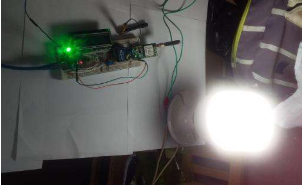
Figura 46. Simulación de encendido de la bomba con foco led.
