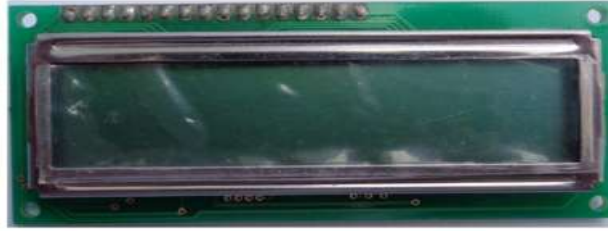
Figura 25. Display LCD AND671GST de 1x16 caracteres.
