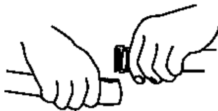
Figura 4.11 Colocación de banda elástica.
