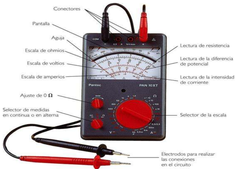
Figura 2.2 Imagen de un multímetro analógico y las partes que lo componen.
