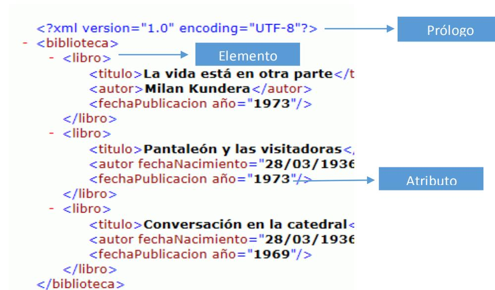
Figura 2. 7 Ejemplo de un archivo en formato XML
