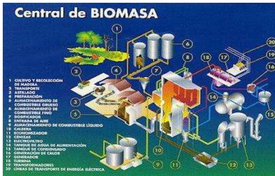
Figura 2. 2 Esquema básico de una Central de Biomasa
