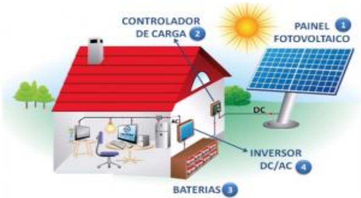
Figura 2. 10 Esquema de generación eléctrica mediante paneles solares
