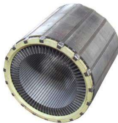
Figura 3. 3 Muestra el laminado de acero en un motor, que disminuye las pérdidas asociadas a los campos magnéticos.
