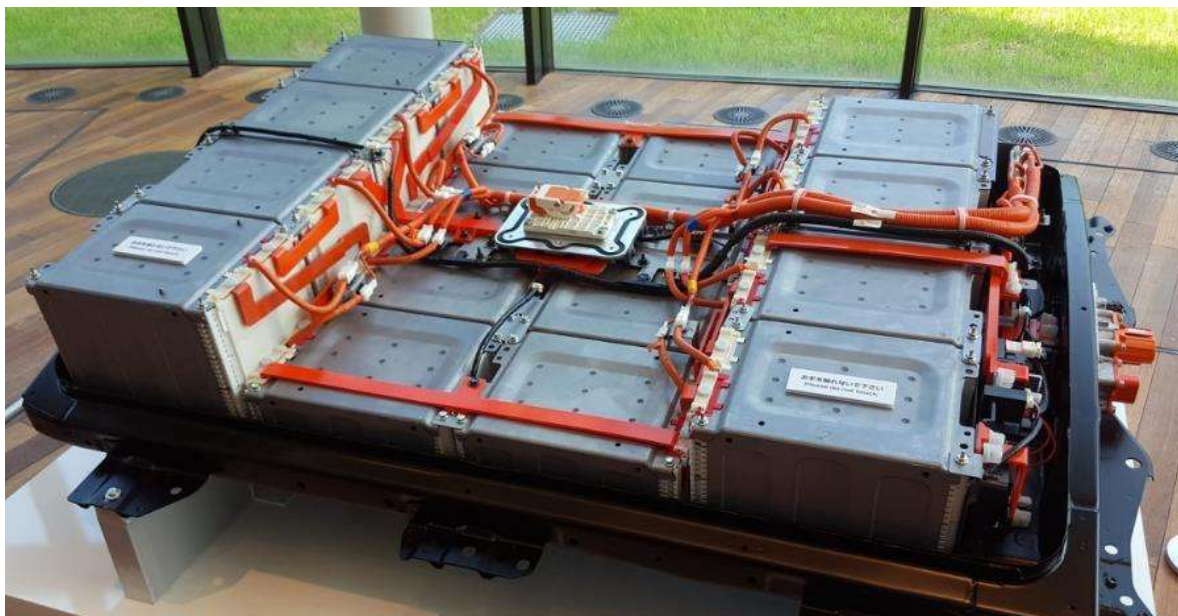
Figura 2. 9 Batería de un vehículo eléctrico litio metal sólido.
