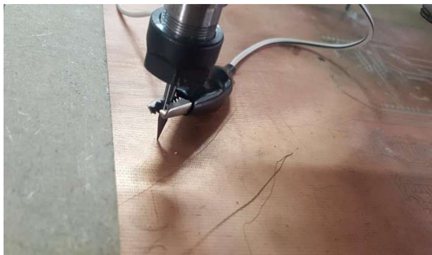
Figura 37 prueba de auto-nivelado
