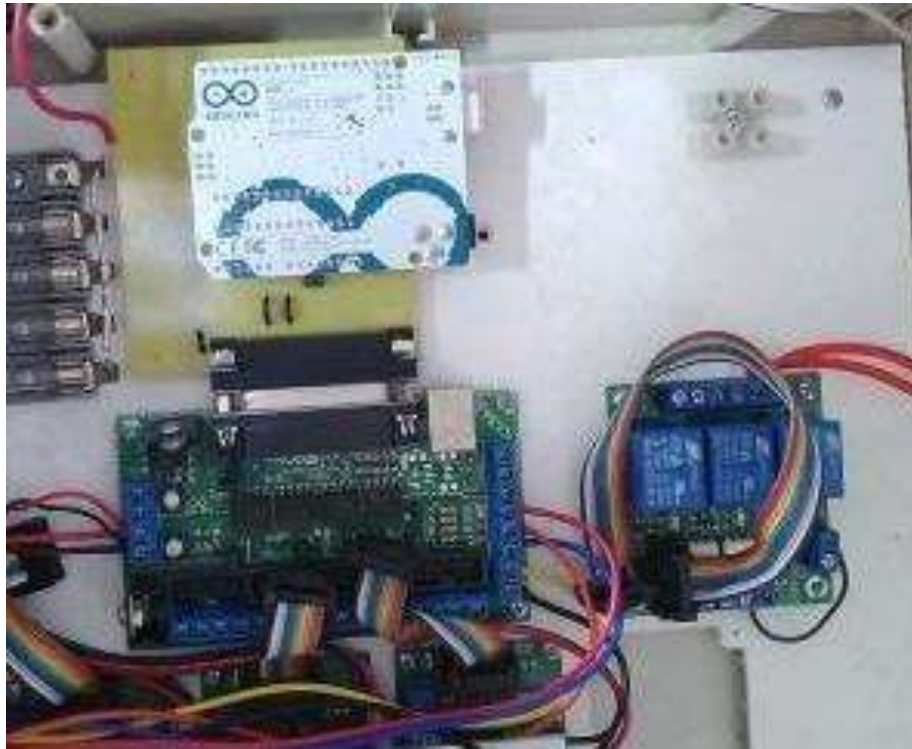
Figura 81 PCB conectada al driver de la maquina CNC
