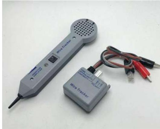
**Imagen 5.2 Generador de tonos y probador de cables.**
