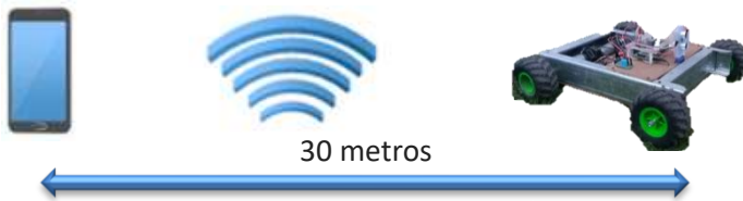
Figura 5-3 Conexión: Smartphone – Interfaz de red Raspberry
