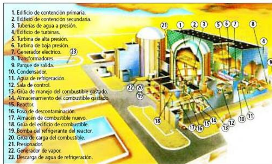
Figura 2. 5. Componentes de una central nucleoelectrica.
