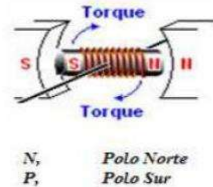
Figura 2.20: Atracción - repulsión de polos, torque del motor.
