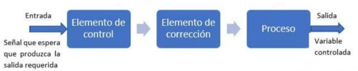
Figura 2.1: Diagrama de bloques de un sistema de control de lazo abierto. [9]
