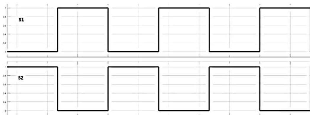
FIGURA 2.17. SEÑALES DE ACTIVACIÓN PARA IGBTs DE INVERSOR MONOFÁSICO.
