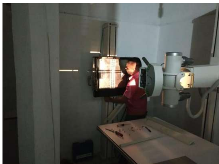
Figura 2.11 Alineación del bucky de pared
