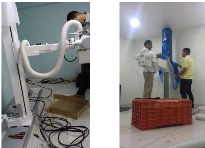
Figura 2.9 Tubo y colimador fijado en el brazo de la columna
