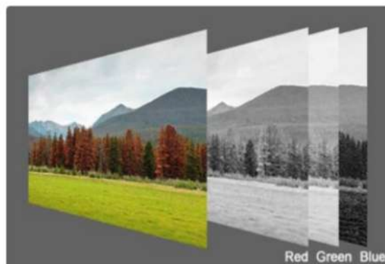
Figura 2.23: Estructura de una imagen RGB
