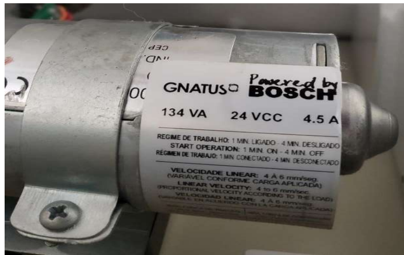
FIGURA 6 CARACTERÍSTICAS DEL MOTOR DEL SILLÓN ODONTOLÓGICO
