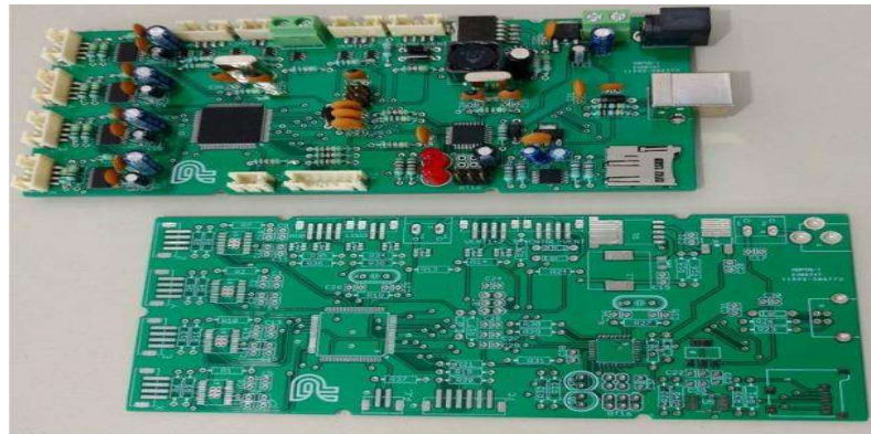
FIGURA 9. PCB CON Y SIN COMPONENTES ENSAMBLADOS
