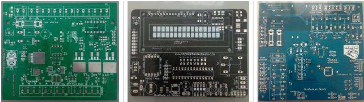
FIGURA 13 DIFERENTES CAPAS SOLDERMASK DE PCB
