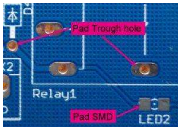
FIGURA 14 DIFERENTES CAPAS SOLDERMASK DE PCB
