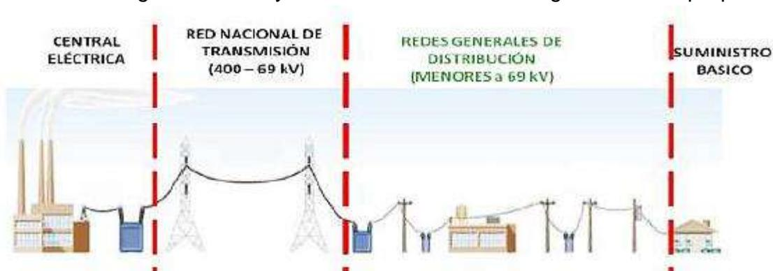
Figura 2.1 Configuración simplificada del sistema eléctrico nacional.
