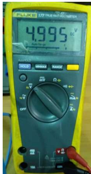
Figura 5. 8 Voltaje de salida del convertidor reductor.
