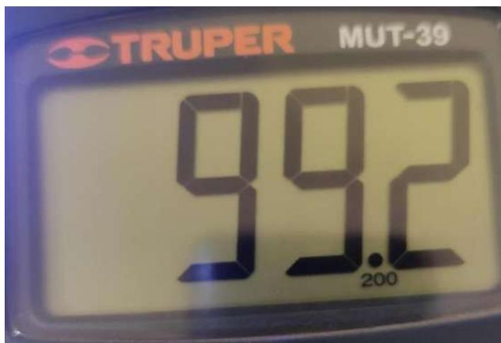
Figura 4.9: Medición de corriente en miliamperes obtenida a un voltaje de entrada de 5V.
