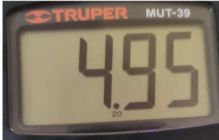
Figura 4.12: Medición de voltaje obtenida a una corriente de entrada de 99.2mA.
