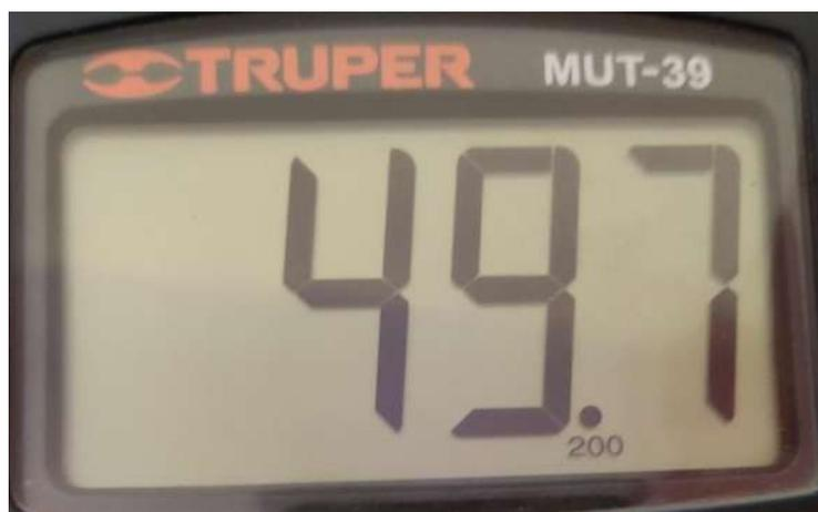
Figura 4.10: Medición de corriente en miliamperes obtenida a un voltaje de entrada de 2.5V.
