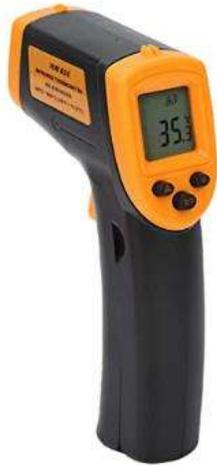
Figura 2.19: Sensor de temperatura infrarrojo.
