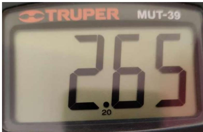
Figura 4.13: Medición de voltaje obtenida a una corriente de entrada de 49.7mA.
