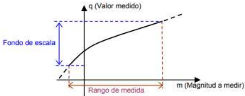
Figura 2.2: Rango de medida del instrumento.
