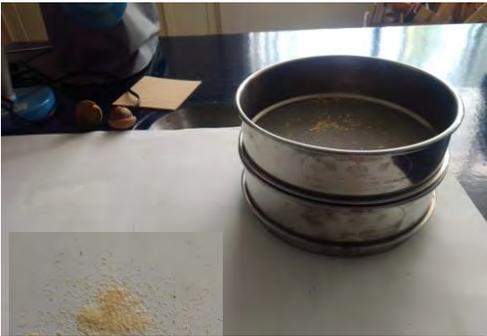
Fig.17. Tamizado con malla No.40
