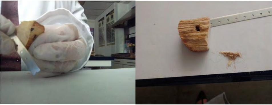
Fig.16. Obtención de virutas con navaja para microtomo
