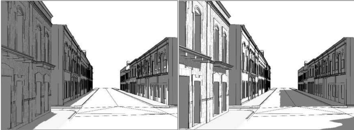
Figura 24 Vista en 3D del solsticio de verano y solsticio de invierno a las 12:00 en el cruce de la calle Madero con Av. Morelos Sur. Fuente: elaboración propia usando Revit
