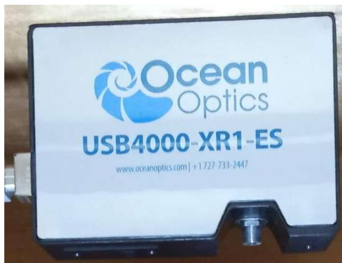
Figura 17 Espectrómetro USB4000-XR1-ES, utilizado para la caracterización de ambas lámparas.
