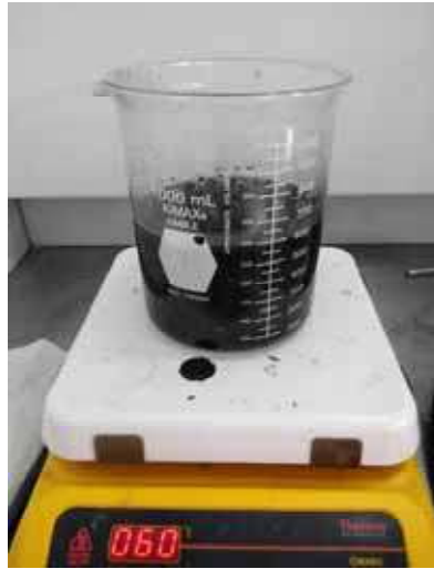
Figura 4.3: Síntesis de nanopartículas de Fe modificada con PMC.
