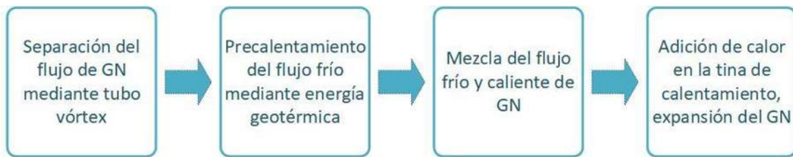
Figura 2.1. Proceso de precalentamiento del GN.
