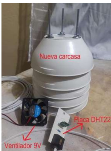
Figura 27. Carcasa de recubrimiento para el sensor DHT22.
