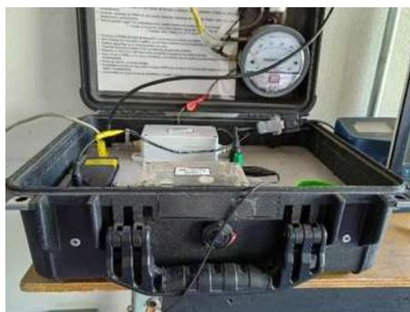
Figura 3.7 **Sistema Portátil de Medición de Emisiones**
