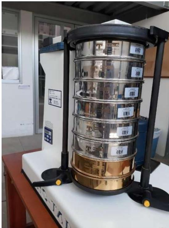
Figura A.7.1 Agitador de tamices RO-TAP
