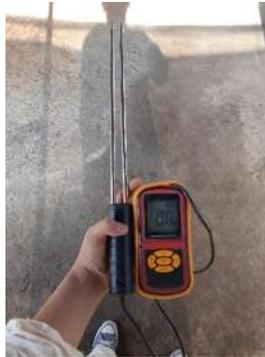
Figura 3.4 Equipo GM640 para medición de humedad en granos
