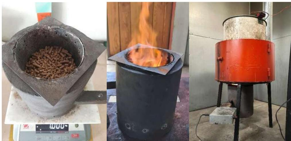
Figura 4.8 Esta secuencia de 3 figuras muestra el pesado de pellets con el dispositivo P3 chupiri, su posterior encendido y finalmente su uso en la Patsari adaptada a la nixtamalera.
