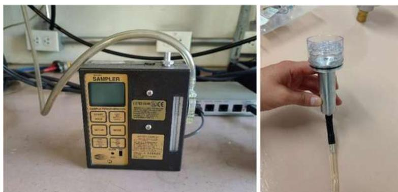
Figura 3.8 **Bomba de succión (derecha) y ciclón (izquierda)**
