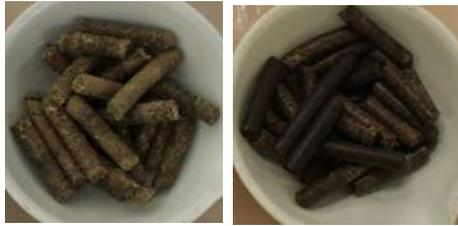
Figura 4.4 Pellets de poda de Arándano (Izquierda). Pellets PT (Derecha).
