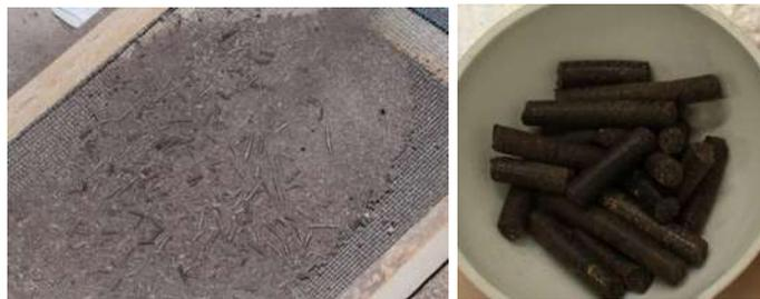
Figura 4.3 Producto del primer intento de peletización de pellets AT (Derecha). Producto final, pellets AT (izquierda)
