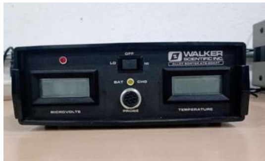
Figura 3.7 Equipo para la medición de potencial termoeléctrico.
